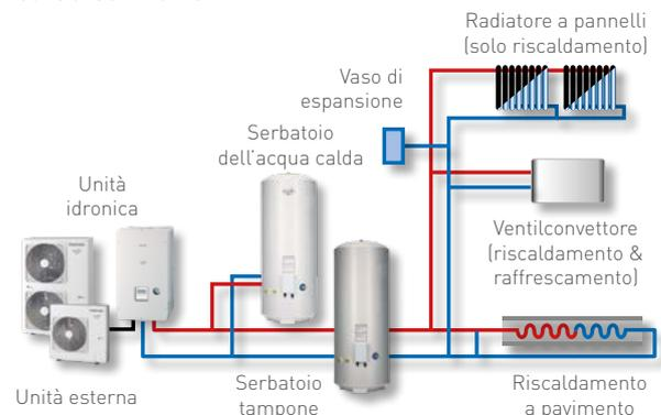
Nelle abitazioni esistenti già dotate di caldaie tradizionali a gas o a combustibile, **il sistema a pompa di calore aria-acqua ESTIA di Toshiba può essere combinato con il sistema di riscaldamento esistente** per coprire e ottimizzare tutte le esigenze di riscaldamento, tutto l'anno. La caldaia viene quindi utilizzata solo come fonte di riserva durante alcuni giorni di freddo estremo durante l'inverno. Il comando intelligente di Toshiba bilancia la fonte di energia nel modo più efficiente.
